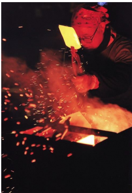
鉋（かんな）造り作業写真
